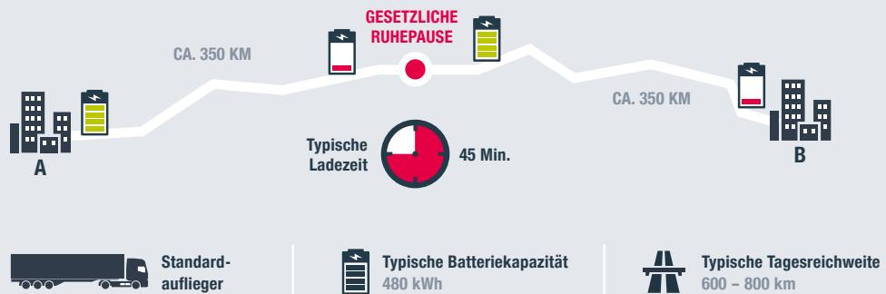
Das Megawatt-Ladesystem ist der Wegbereiter für den Fernverkehr. Mit einer Ladeleistung von bis zu 1.000 kW lässt sich ein typischer Elektro-Lkw innerhalb von 45 Minuten vollständig aufladen. Unter Berücksichtigung der gesetzlichen Einschränkungen der Lenkzeiten können 2 Fahrschichten von je 400 km an einem normalen Arbeitstag mit einer einzigen Ruhepause erreicht werden.
