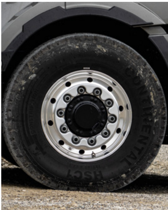
Eje delantero con motor hidrostático en el cubo de la rueda.
