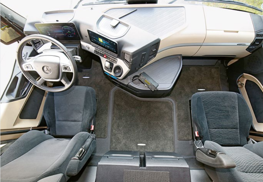
Nahezu frei von Schaltern: Mercedes-Benz setzt auf eine Bedienung per Touchscreen
