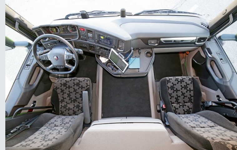
Seit Jahrzehnten typisch für die Marke Scania ist der zum Fahrer hin angewinkelte Armaturenräger, der für beste Bedienbarkeit und Ergonomie sorgt
