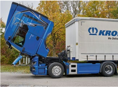
Die Kabine des Testfahrzeugs kippt elektrisch
