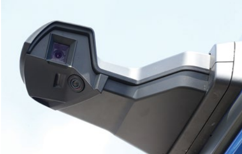
Das OptiView-System arbeitet mit einer Direktsicht- und einer Fischaugen-Kamera
