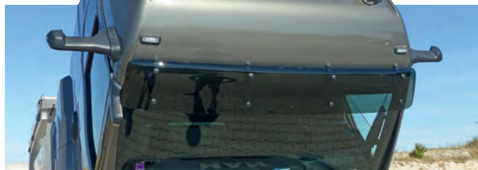
Dachlandschaft: nur zwei Antennen, elektrisch betätigte Dachluke. Die Ausleger für die Kameras reichen weit nach außen, aber in gefährlicher Höhe. Die kleine Weitwinkelkamera sitzt rechts an der A-Säule.
