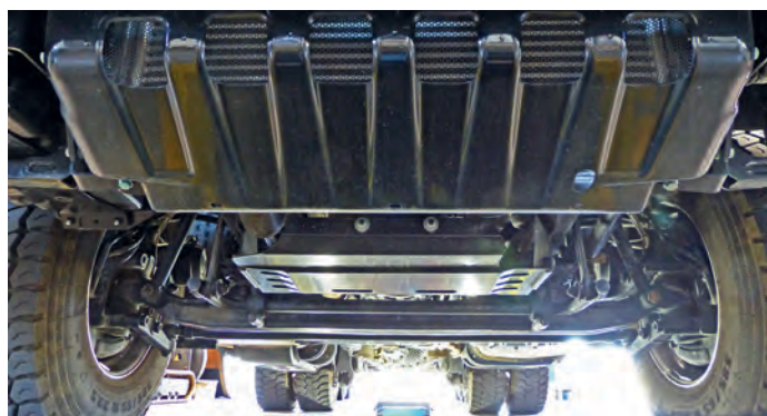
Ab dem Vorderachskörper ein sauberer Tunnel ohne hervorstehende Teile. Stabile Prallschutzbleche für Ölwanne und Kühler.
