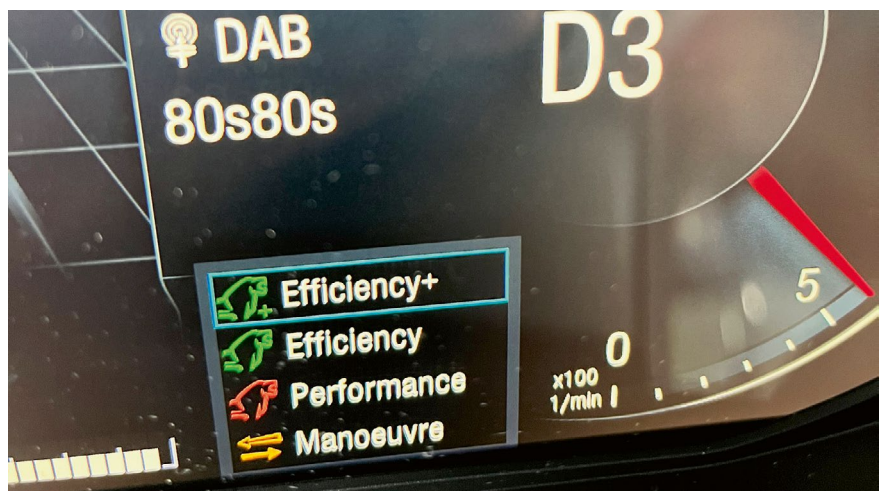
Serienmäßig rollt der MAN mit vier unterschiedlichen Fahrmodi aus dem Werk
