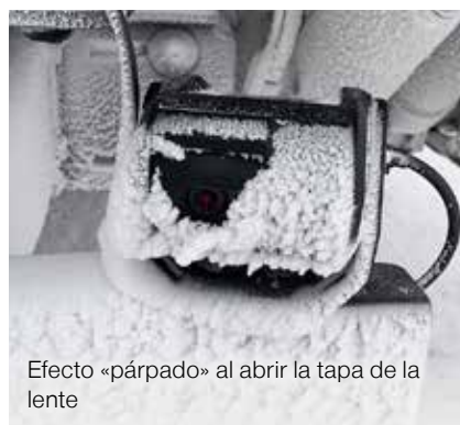
Cámara lista para usar incluso con nieve gracias a la carcasa del obturador
