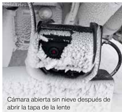
Efecto «párpado» al abrir la tapa de la lente
